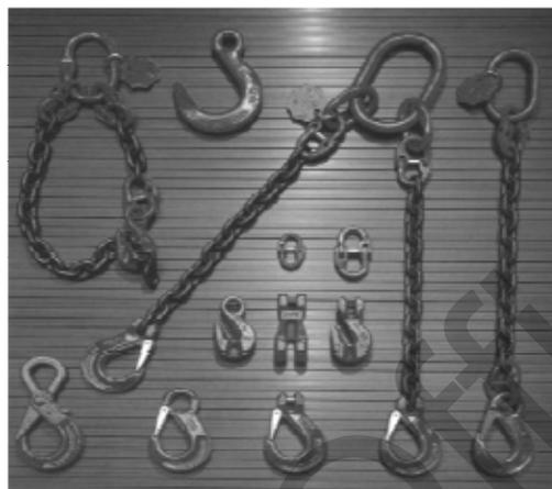
Ha caratteristiche di resistenza al danneggiamento sicuramente superiori a quella a fune, ma è meno flessibile e quindi non adatta per realizzare alcune tipologie di tiro. Rimane confermato il grado di attenzione per ciascun anello della catena in quanto il cedimento di uno solo di essi causa il collasso dell'intero accessorio
