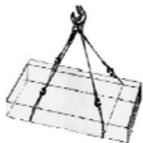
E' poi necessaria la conoscenza della posizione del baricentro del corpo in quanto la configurazione di equilibrio durante il sollevamento si ha solo se sussiste l'allineamento sulla stessa retta verticale del gancio e del baricentro
