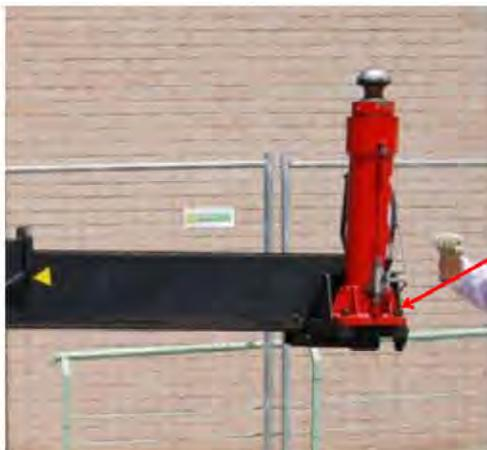
Dispositivo di ribaltamento del martinetto stabilizzatore
