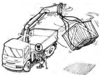
Usare imbragature corte ed azionare le leve con gradualità e dolcezza allo scopo di evitare pericolose oscillazioni del carico
