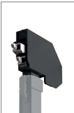
Svetruck 592 4 twistlock orizzontali per doppia movimentazione
