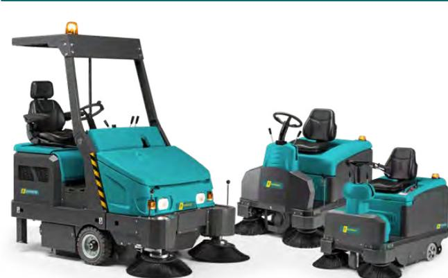
La linea Total Steel identifica spazzatrici con scocca rinforzata, per una maggiore durata nel tempo. La carena in acciaio avvolge il corpo delle macchine, mentre speciali lastre di rinforzo ricoprono il blocco delle spazzole laterali.
